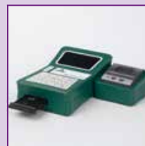
扫描校准曲线条码并读取检测结果
