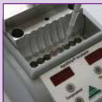
将试纸和稀释后的提取液加入抗体包被孔，在加热器中恒温3分钟
